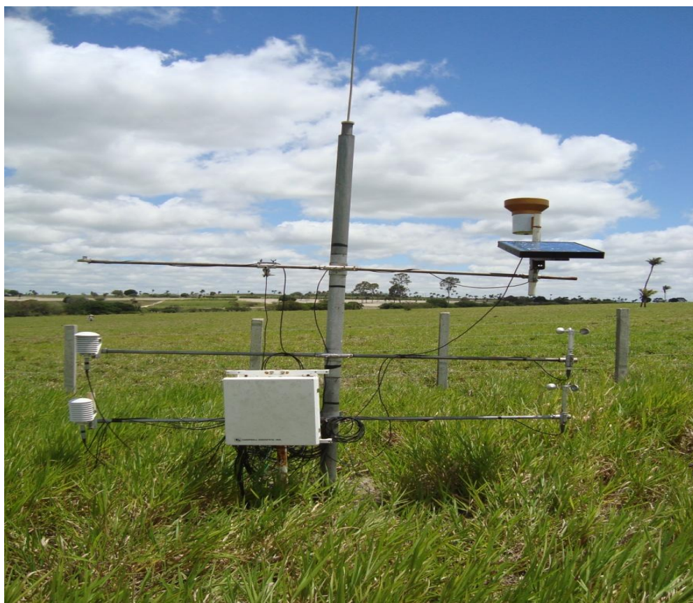
Figura 2 – Torre micrometeorológica automatizada instalada na área experimental para a realização do balanço de energia
