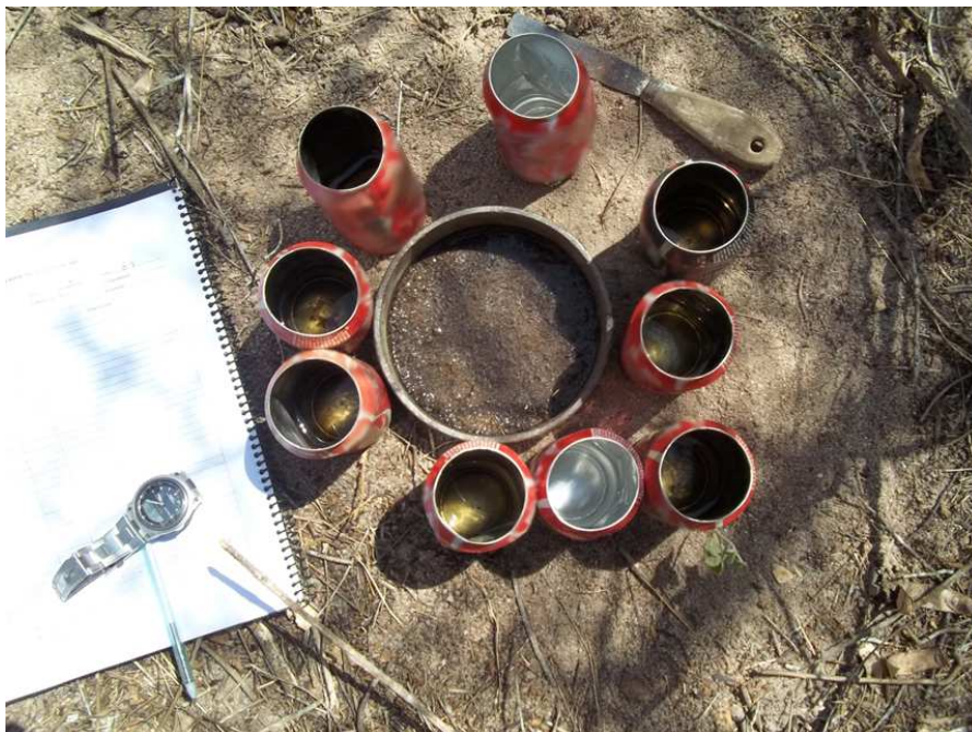
Figura 3. Teste de infiltração tridimensional com infiltrômetro de anel (150 mm de diâmetro)
